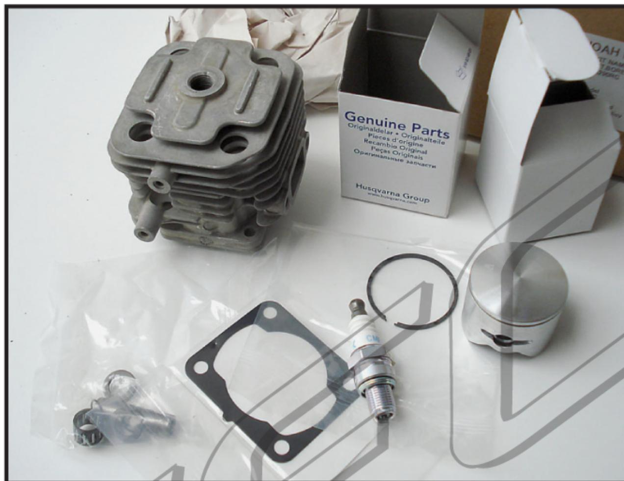
Este manual contiene las instrucciones para realizar el recambio del conjunto cilindro, aro, pistón y perno del motor ya sea por mantenimiento o reparación. El detalles de los pasos son idénticos para llevar a cabo el upgrade del G 270 RC de 25,4 Cm. Cúbicos y 3 Hp, al G 290 RC de 28,5 Cm. Cúbicos con 3,5 Hp, adquiriendo el kit correspondiente para este propósito.
