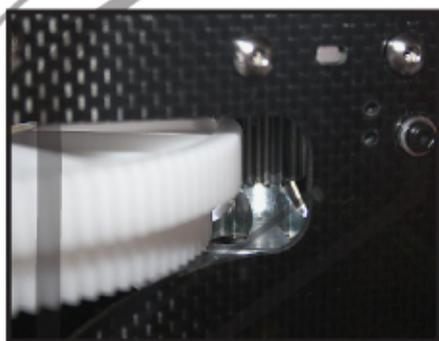
Completado este paso, colocar el eje principal y el conjunto de la corona y verificar que la distancia con el piñón sea la correcta.
