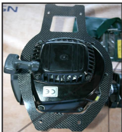
Ahora retire los tornillos y presente la base. El piso tiene una sola posición. Observe el detalle de la entrada en el carbono que coincide con el botón de apagado del motor.
