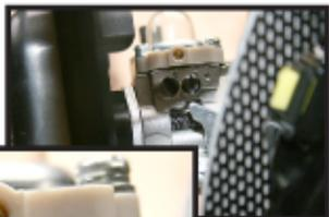
En la parte inferior de carburador hay dos (2) tornillos indicados o señalados con las letras "L" y "H".
