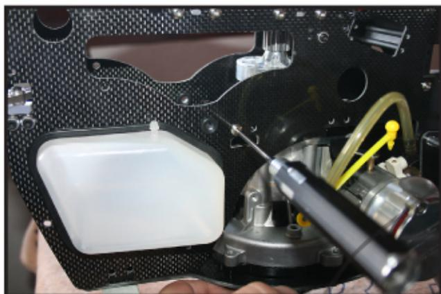
En orden se colocará de un tornillo, continuando por el tornillo de la bancada de motor a la derecha, después uno y otro de la bancada, pero del chasis opuesto.
