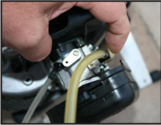
Después de verificar la apertura de los tornillos de baja y alta, realizar la conexiones necesarias, y tener combustible preparado, estamos listos para intentar el arranque del motor.
