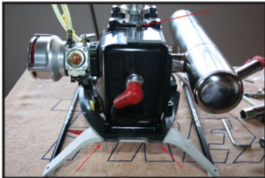
Este paso es aconsejable realizarlo después del ablande del motor. Antes de presentar el motor en el chasis de forma definitiva, es ideal realizar un chequeo de la presión de ajuste de los tornillos del cilindro.
