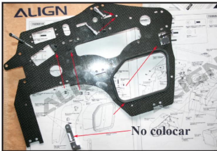
La pagina diez (10) del manual Align muestra la disposición de piezas en el armado de un lateral.
