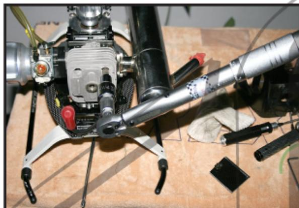
De ser posible utilice para esta tarea un torquímetro con escala en Newton/metros o realice la conversión a la escala indicada en su herramienta. Con la medida de una llave Allen de 4 mm reajustar los tornillos del cilindro en forma de cruz (ejemplo en fotografía) hasta alcanzar el valor indicado en el manual . (6,8 New/kgm)
