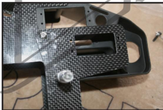
La placa provista para montaje del servo de acelerador se presenta y queda fijada al chasis, como muestra la gráfica de la izquierda.
