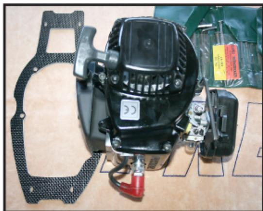
Con la llave ALLEN adecuada se procede a aflojar cada uno de los cuatro (4) tornillos de la base del motor. No intente retirar cada tornillo, solo afloje cada uno de ellos. Sentirá una fuerte resistencia inicial ( forzar hasta escuchar el chasquido de liberación)
