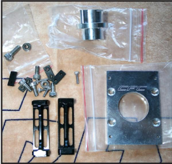
Buscar en la bolsita que viene en el Kit, el soporte del motor y las 2 Monturas HN7084 Align. Seleccione los cuatro tornillos más finos e iguales que se utilizarán para fijar las monturas HN7084 al soporte del motor .
