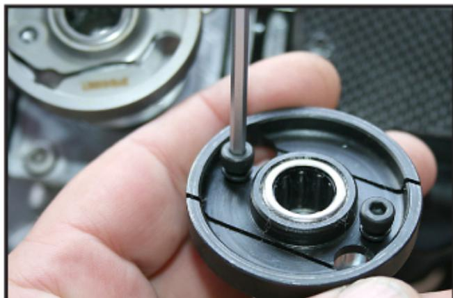
Busque en el Kit del 700 Align el embrague que se encuentra montado sobre la bancada para el motor glow.
