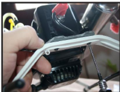
Desajustar los tornillos del tren de aterrizaje, delanteros y traseros, para permitir que los soportes se deslicen libremente posibilitando hacer coincidir su posición con las entradas del chasis.
