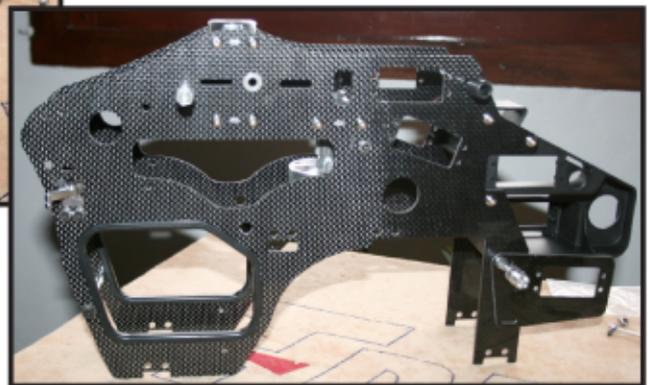
En ambas se puede apreciar la falta de todos los soportes destinados al montaje del motor 91.
