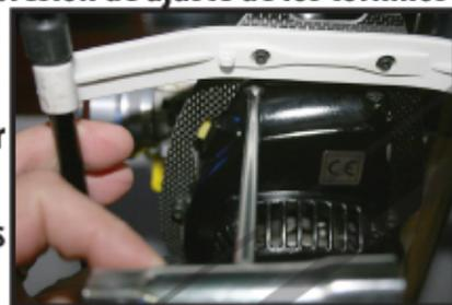
3 (Tres) tornillos señalados en la fotografía, uno en la parte superior del túnel de ventilación y 2 (dos) en la parte inferior ayudados por la llave saca bujías suministrada con el motor.
